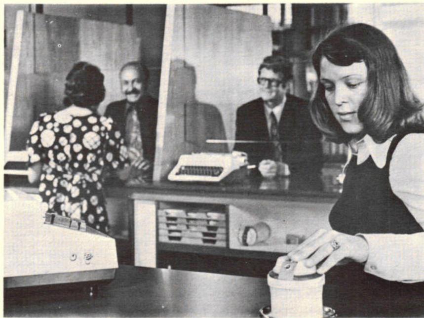
Een afdoende bescherming tegen bankovervallen aan het loket; met buizenpost worden bankbiljetten, enz. naar een veilige plaats overgebracht (foto Ergon Electric).
